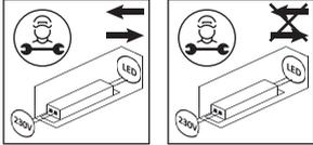
Separates Betriebsgerät durch Fachkraft austauschbar / nicht austauschbar.
