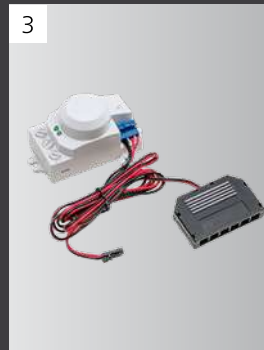
Alternativ ist der Bewegungsmelder mit LED-Treiber für den Festanschluss 230 V einsetzbar. Das Gerät kann unsichtbar im Möbel verbaut werden, die elektromagnetischen Wellen gehen durch den Korpus hindurch (Laufzeit bis 20 Min.).
